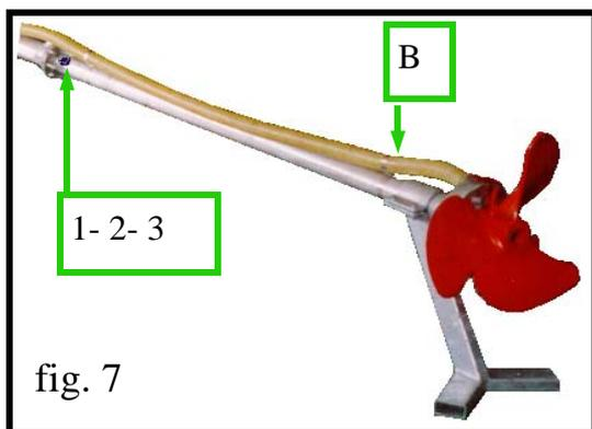
**N.B. A macchina ferma, durante il riempimento e i controlli, il tubo di trasmissione deve essere in posizione orizzontale.**
